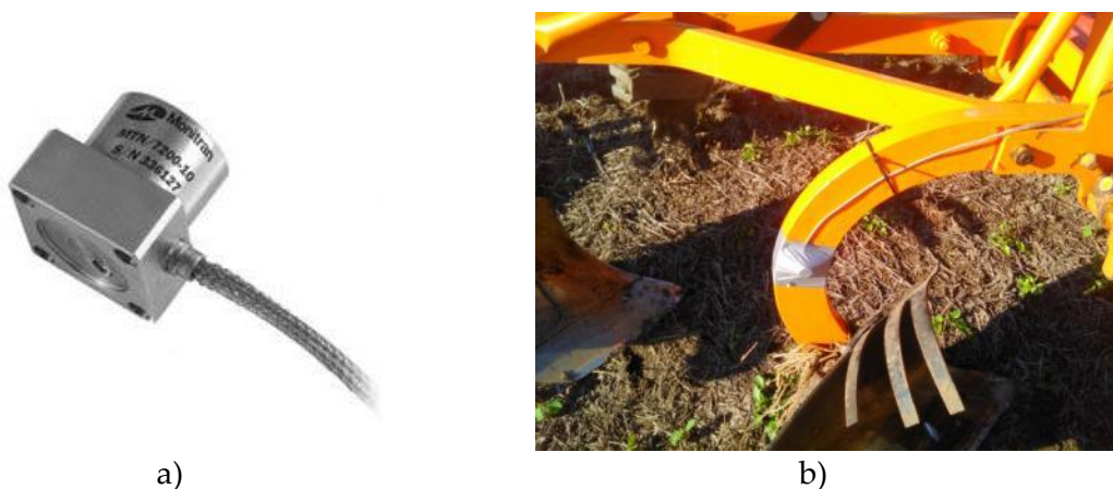
Slika 1.4. Akcelerometar korišćen tokom merenja: a) piezorezistivni akcelerometar MTN 7000; b) pozicija na nosaču plužnog tela
